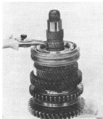
**Bild G 21. Sicherungsring**
