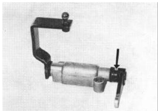
**Bild G 17. Kerbstift für Hebelwelle**
