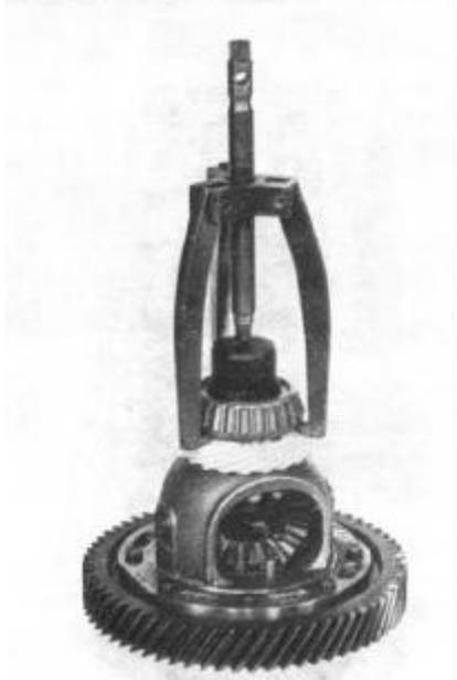
Bild G 26. Lagerinnenring des Kegelrollenlagers abziehen
