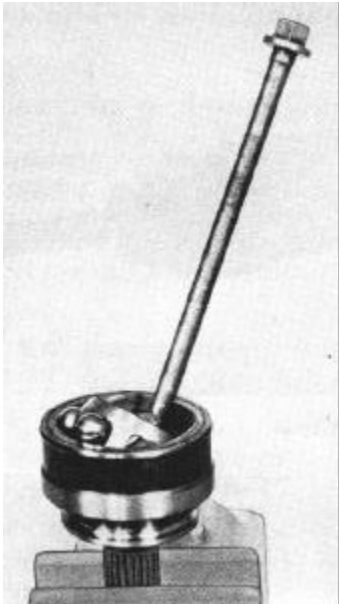
Bild F 21. Demontage des Gelenkes
