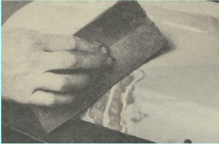
Bild 9 Abschleifen des überstehenden Klebers
